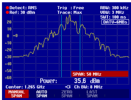
Spectre d'une émission ATV FM
